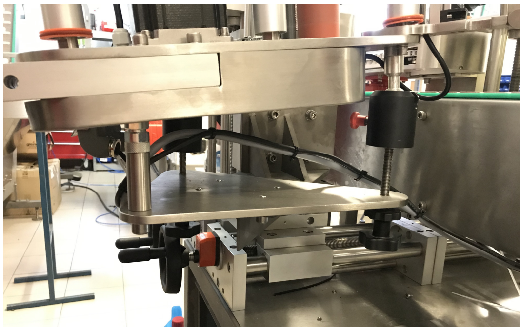
Rys. 8. Ustawienie kątowe ujemne, widok na trójkąt regulacyjny.
