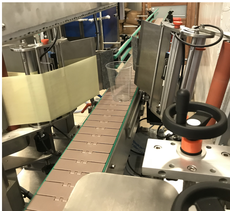
Rys. 9. Ustawienie kątowe ujemne, widok od strony transportera.
