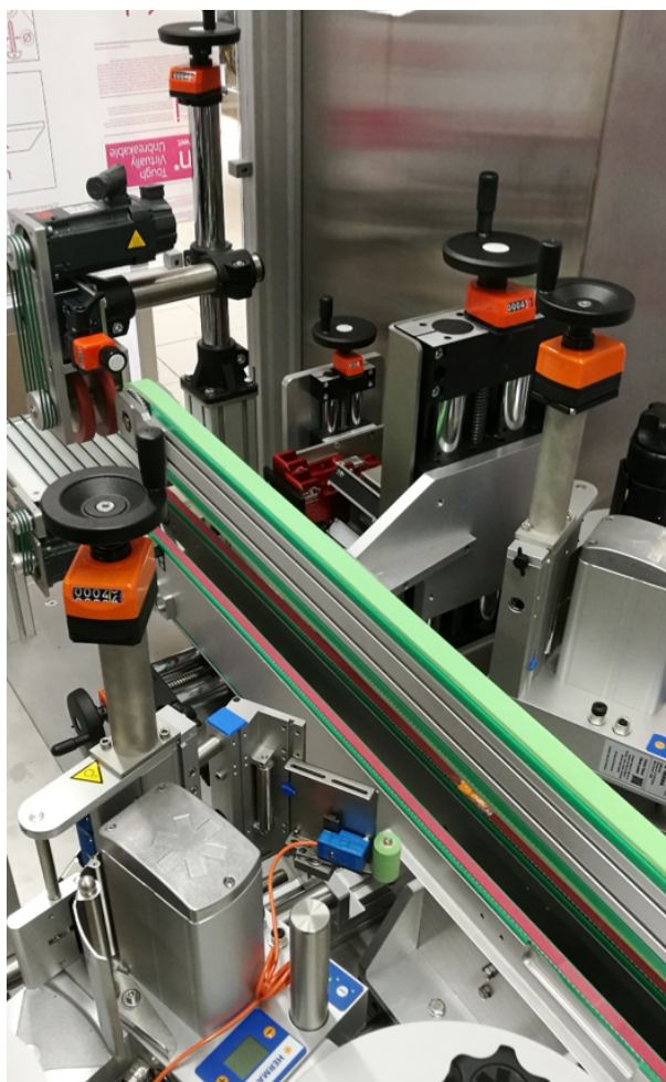
Rys 3. Mechanizmy 291 i GN 492 w aplikacji maszyny serializacyjnej dla farmacji. Producent Firma Inżynierska Tadeusz Wędzony.
