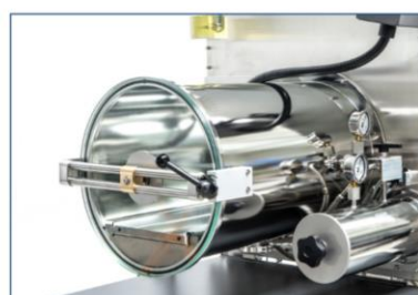
Zdjęcie 2. Dźwignia z krzywką jako szybka funkcja zamykania drzwiczek urządzenia do produkcji gumowych rękawic.
