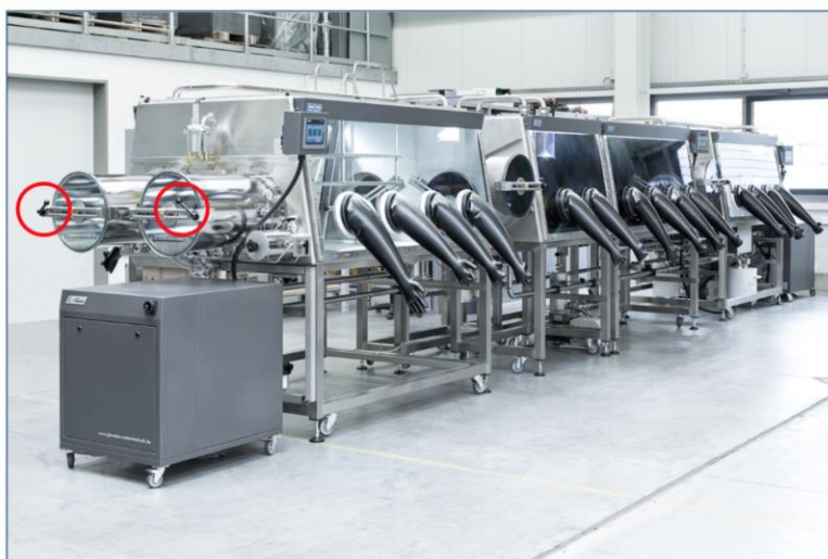
Zdjęcie 2. Dźwignia z krzywką jako szybka funkcja zamykania drzwiczek urządzenia do produkcji gumowych rękawic.
