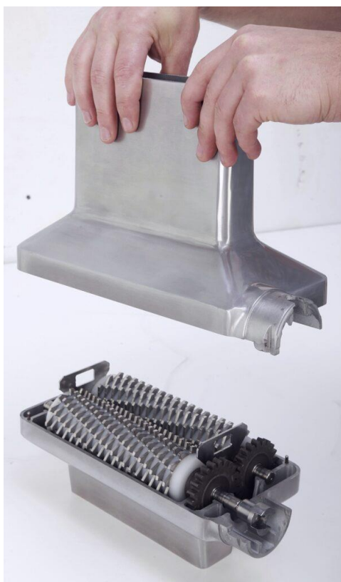
Rys. 3. Segmenty ugniatające wewnątrz modułu kotleciarki KM20 produkcji Ma-Ga napędzane kołami ZCL
