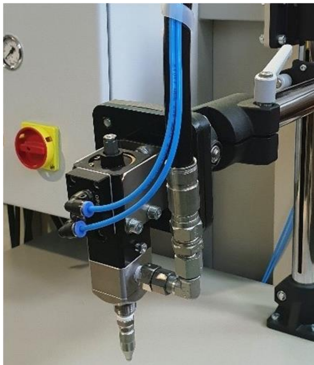
Rys 4. Łącznik przegubowy z dźwignią nastawną do regulacji kąta.
