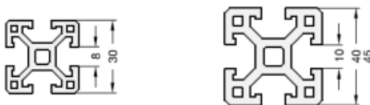
Rys.2. System profili kompatybilny z zestawami montażowymi GN 968
