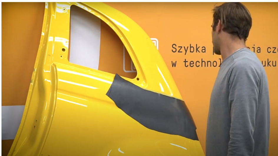
Rys. 2 Proces wyznaczania linii odcięcia za pomocą folii magnetycznej.
