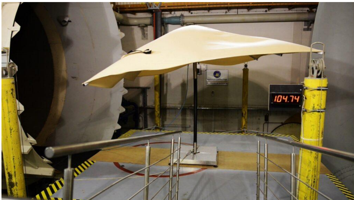
Rys. 9: Parasol Atlantic podczas testów w tunelu aerodynamicznym
