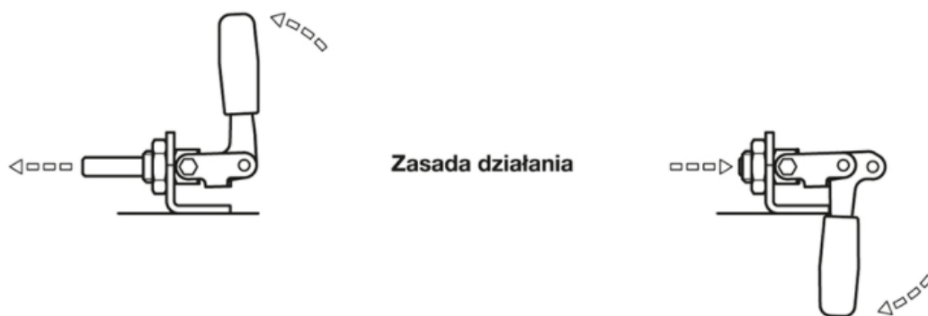
Rys. 2. Mechanizm napinacza suwakowego przekształca ruch wahadłowy ramienia na ruch osiowy trzpienia
