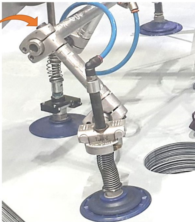
Rys. 3: Zastąpienie śruby pasowanej dźwignią GN 927
