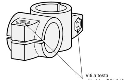
Viti a testa cilindrica DIN 912
