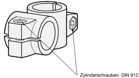
Zylinderschrauben DIN 912
